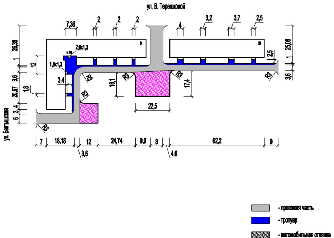
Внутривороней проезд выполнен из асфальтового покрытия. Асфальтовое покрытие разрушено имеются многочисленные выбоины и трещины. Тротуары и парковочные места отсутствуют.
